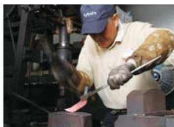
赤く焼けた材料が打ち鍛えられ、鎌へと形を変えていく
